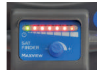
Integrierter Satfinder, zusätzlich mit ID-LED
