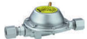
9 VORDRUCKREGLER TYP DE 50/30 S 0,8kg/h, 30mbar, bds. RVS8. Zur sicheren und normgerechten Integration von 30mbar Gasgeräten in 50 mbar Flüssiggasanlagen in Fahrzeugen und Booten.
