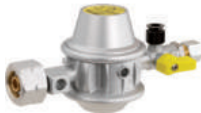
7 NIEDERDRUCKREGLER TYP EN61-DS (1,5 KG/H) PS 16 BAR Zum Anschluss an fest am Fahrzeug installierte Gasbehälter (z. B. Gastank). Inkl. Überdrucksicherheitseinrichtung, mit Prüfeinrichtung. 30 mbar/1,5 kg/h Anschluss Komb. A. x RVS 8.
